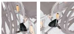
片側のレバー操作で左右同時にブレーキをかけることのできる駐車ブレーキです。操作側(左右)の切り替えは、ネジこみ式のレバーを手で付け替えるだけでできます。
